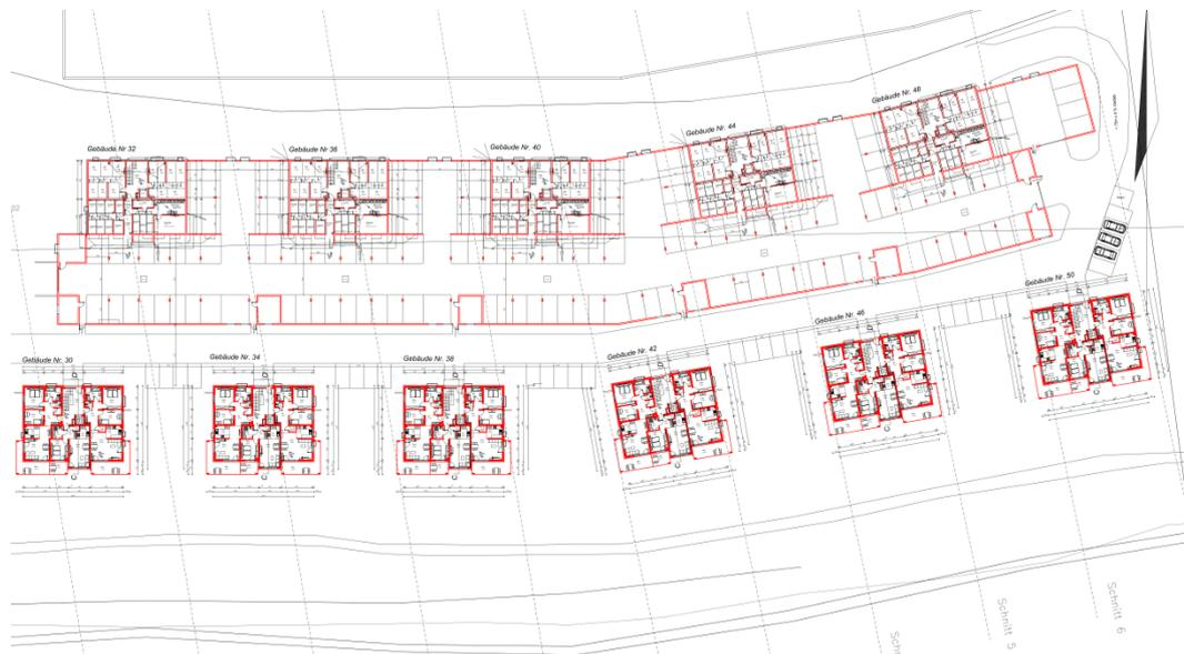
**Abbildung 9:** Grundrissdarstellung der Ebene 2 mit Darstellung der Tiefgarage und Kellergeschoss, klimaneutrales Wohnquartier, Barockschloß Stetten GmbH, Stand 27.01.2022
